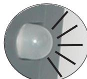
La lumière verte indique que l'ajustement du signal est correct. Si aucun réglage de la molette ne permet d'obtenir la lumière verte, il se peut que le sélecteur A,B,C (page 8) soit placé sur une position d'enclos inadaptée. Dans ce cas il faut le faire avancer ou reculer d'un cran ce qui devrait résoudre le problème.
