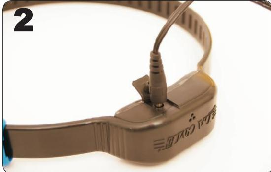
Otez la languette de protection puis branchez le chargeur. La LED se met alors à clignoter alternativement rouge et vert, signe que la batterie est en charge.
