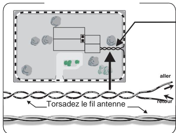
**Passage sans signal :** en accolant une partie "Aller" de l'antenne à une partie "Retour" les deux signaux émis s'annulent. On réalise donc un passage sans signal dès que l'on torsade (ou scotche) ensemble un segment "Aller" et un segment "Retour" de l'antenne.
