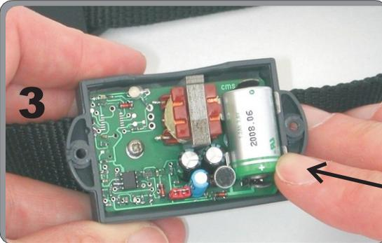
Ouvrez le couvercle et insérez la pile en prenant soin de bien respecter la polarité (+) et (-) de la pile. Un BiiiiP sonore de 2 secondes se fait entendre.
