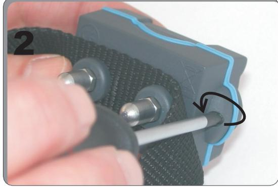
Dévissez les 2 vis situées au dos du boîtier à l'aide d'un petit tournevis cruciforme.
